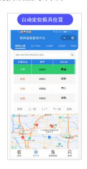
EMITTIMS模具智能计数器是广东新睿仕德智能系统有限公司开发的模具智能化数据采集器,属于无源设备互联智能化数据采集器。产品自带无线定位模块、计数模块和数据传输模块。主要功能是自动为模具提供位置信息、数量信息和成型周期等信息,利用以上信息通过软件系统大量逻辑运算为模具全流程监控和运营提供智能化管理。运营管理平台主要解决大量模具在注塑和冲压生产过程中运营管理难的痛点问题,应用场景:主机企业(美的、华为等)有大量模具外发多家供应商生产[MITT模具生产运营智能管理系统化解决方案,通过模具智能RFID数据采集器[]4G[]5G智能采集器配合智能化管理系统对模具进行全生命周期管理,解决企业大量模具外协供应商生产难以运营管理的痛点问题。计数架构:每套模具安装智能数据采集器一个(内置定位、计数、通讯模块)自动采集数据;系统通过4G[]5G通讯基站定位及传输数据,云端服务器数据运算;云端服务器运行智能化管理系统,通过系统完成数据智能化运算,展示在企业PC端、移动端和电子看板;通过模具智能数据采集器实时采集数据,云端计算,通过PC端、移动端和电子看板呈现数据报表、异常实时提醒等智能化管
